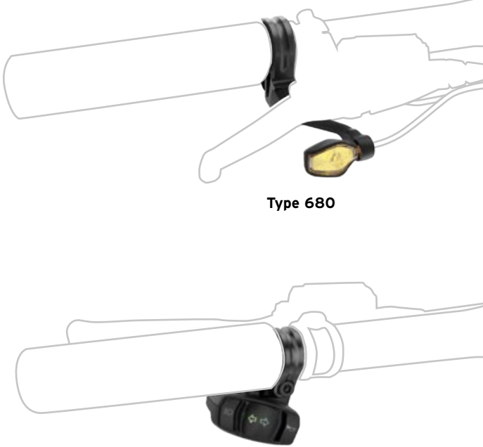
Bedieningsunit voor S-pedelecs met een drukknop voor grootlicht en claxon
